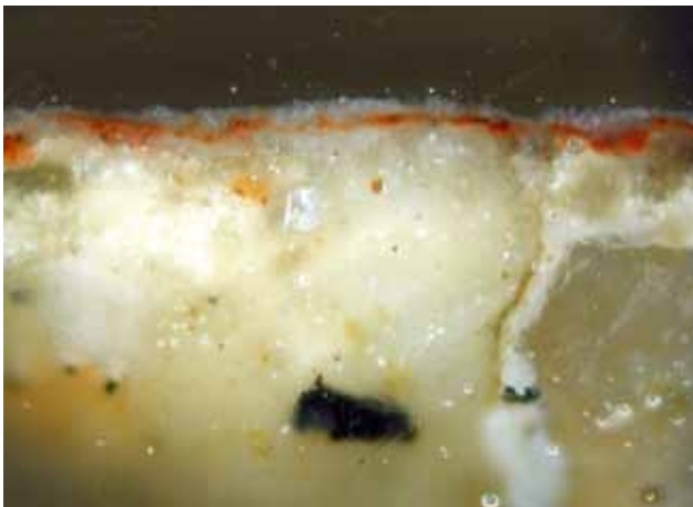
[15] Weißer Gipsbelag über rotem Pigment (Mennige), lichtmikroskopische Untersuchung am Querschliff, Bildbreite ca. 1,5 mm
