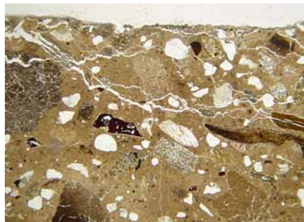
[5] Malereitragender Gewölbeverputz, Dünnschliff, linear pol., Bildhöhe 9 mm
