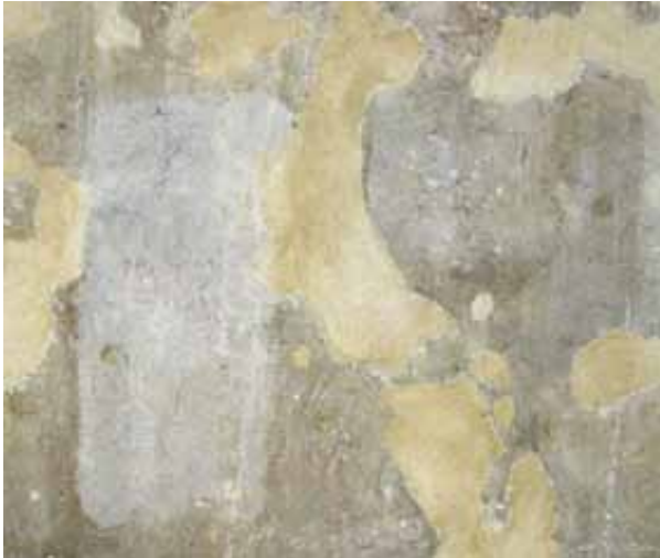
Abb. 13 Probestfläche Nr. 02 nach der Behandlung, Vergleich der Testflächen Niederdruckverfahren (links) und Kompressenbehandlung mit Diffusionsdruck (rechts).
