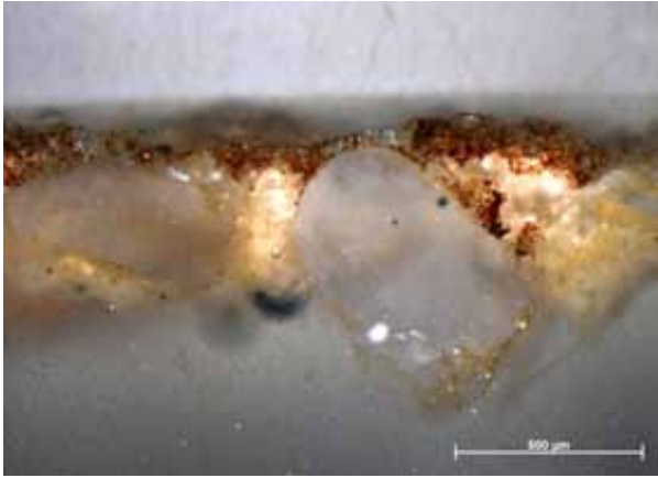
Abb. 16 Poröse Oberfläche vor der Behandlung, in die Poren eingedrungener, rot angefarbter Kunststofffilm.
