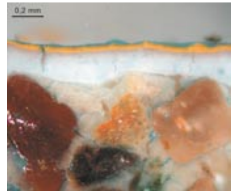
Abb. 20 Keinerlei Penetration des angefärbten Polymers (Plextol D498) bei verdichteter Oberfläche, Mörtel mit Kalktünche und Farbschicht.
