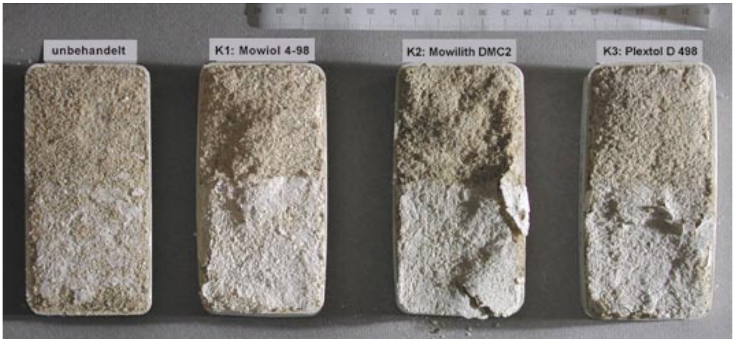
Abb. 21 Salzbelastete Probekörper (NaCl) nach der künstlichen Bewitterung, mit Steiflicht von rechts (der Zeiger am Schlagschattenlineal hat eine Höhe von 2 cm).
