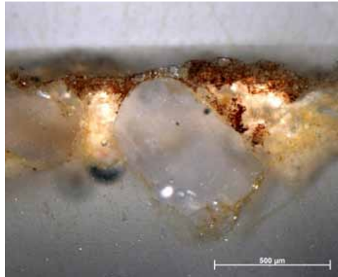
Abb. 20: Poröse Oberfläche vor der Behandlung, in die Poren eingedrungener, rot angefärbter Kunststofffilm
