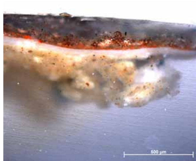
Abb. 21: Dichte Oberfläche vor der Behandlung, auf der Oberfläche aufliegender, rot angefärbter Kunststofffilm
