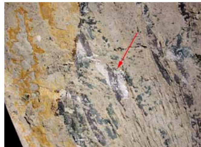
Abb. 1: Die ursprüngliche Putzfarbigkeit, durch vormals aufliegende Tünchereste bewahrt, verdeutlicht die Intensität der Farbvertiefung und Vergilbung des Polymerfilms, Quedlinburger Gewölbmalereien, Bildbreite ca. 6,5 cm
